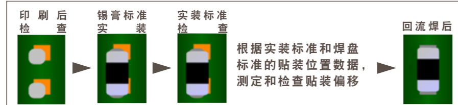
发生锡膏印刷偏位 偏位的自动纠正
