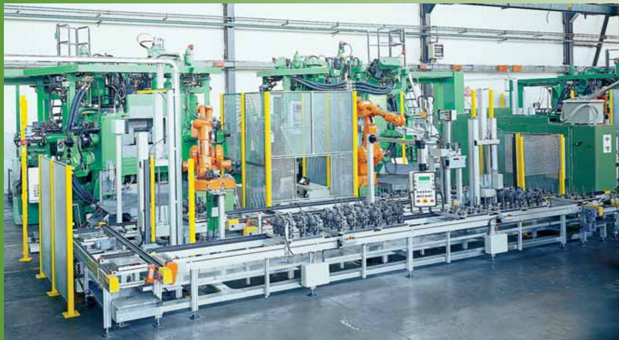
Flexible production cell with automatic part transfer from the first to the second machine Flexible Produktionszelle mit automatischem Werkstücktransfer von der ersten zur zweiten Maschine
