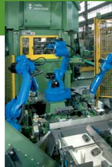
Checking for through hole presence Bohrungsüberwachung und Laden
