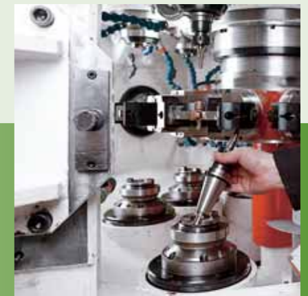
Quick change tool-holder with power draw bar Schnellwechsel-Stahlhalter mit kraftbetätigter Anzugsstange
