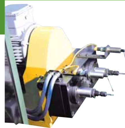
Broken tool detector Werkzeugbruch-Überwachung
