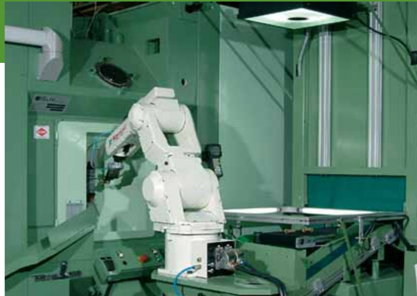
Loading/unloading equipment with robot and vision system Be- und Entladeeinrichtung mit Roboter und Visions-System
