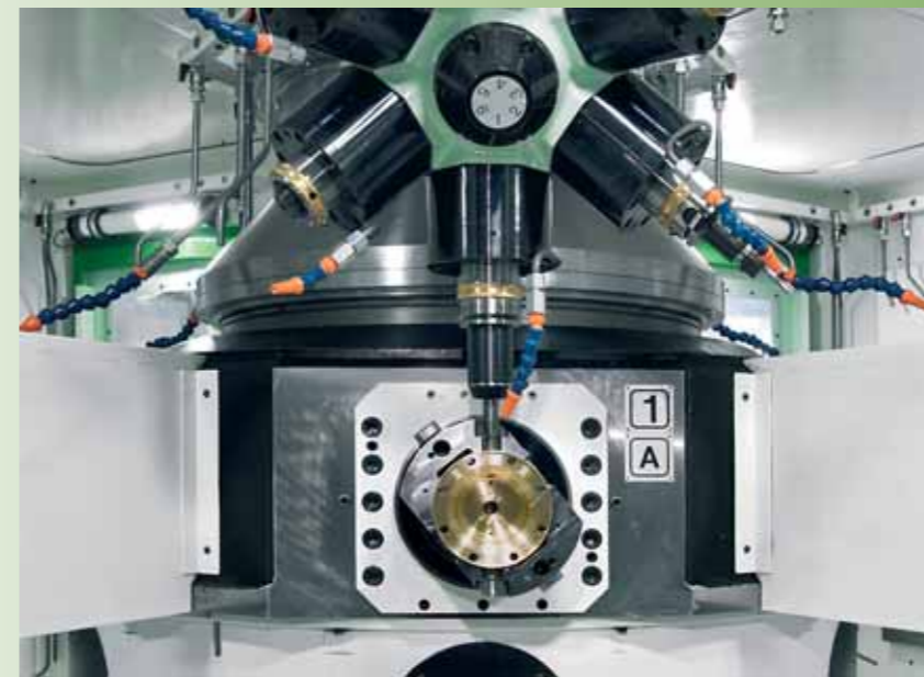
CNC turret head working on CNC turning chuck CNC-Revolverkopf und selbstzentrierendes Drehfutter
