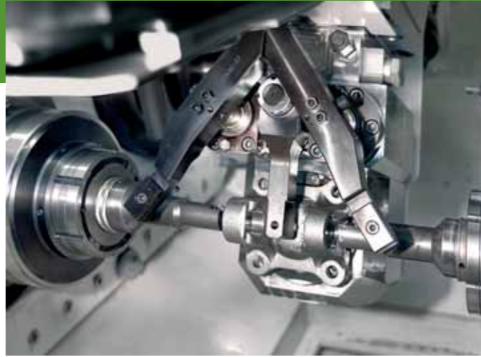
Hydraulically operated special clamping fixture Spezial hydraulisch-betätigte Spanneinrichtung
