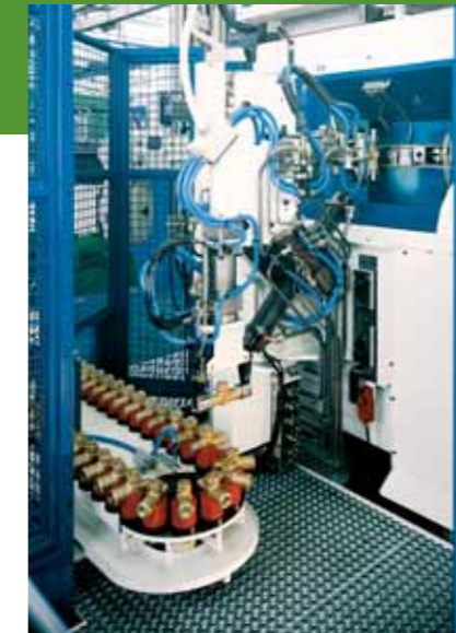
Chain conveyor magazine with 180° rotating two-arm pick and place unit, mounted on a Vertimac machine Kettenbandförderer mit Pick and Place – Beschickung mit 2 Armen an einer Vertimac Transfermaschine
