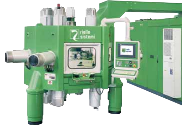
VERTIMAC MACHINES Used for machining families of complex parts at a very competitive cost per piece VERTIMAC MEHRWEGEMASCHINEN Sie werden wirtschaftlich zur Bearbeitung von Teilefamilien und komplizierten Teilen eingesetzt
