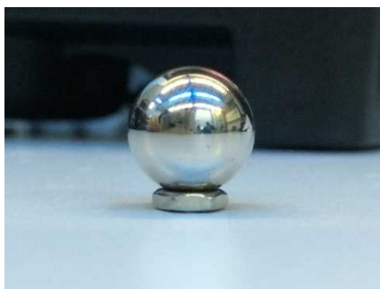
各種デジタイザが苦手とする鏡面及び急勾配な製品
