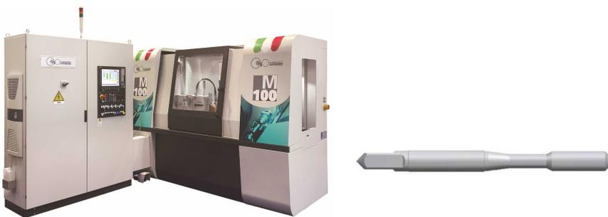
コンパクトなセンタレス研削盤 M100 は、径 0.50-20mm、長さ 130mm までの中・大量生産部品のスルーフィード研削またはプランジ研削に特に適しており、インダストリー4.0にも対応します。砥石ヘッドは、流体動圧スピンドルと  $\varnothing 450\text{mm} \times L130\text{mm}$  の砥石、自動砥石バランスングを搭載し、モータ出力 11kW、最大周速 50m/s (63m/s オプション) を提供します。
