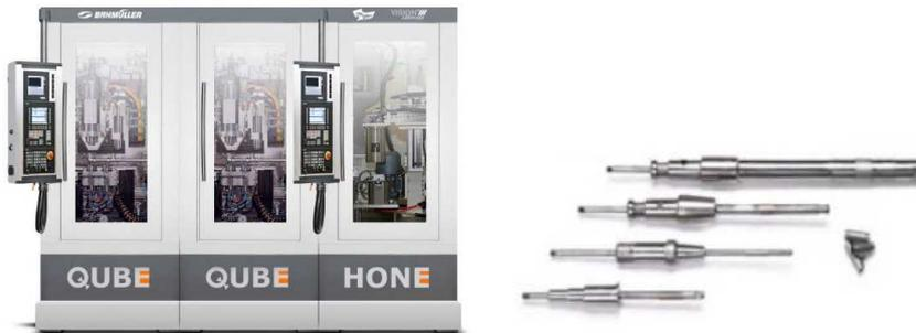
通常ホーニングはいくつものツールを経て加工されますが、デーゲン社製高速ホーニングは粗、中仕上げ、仕上げといった工程ごとの異なるホーニングツールは不要です。ワーク側を高速で上下運動させ、パテント取得済みの特殊仕上げホーニングツールだけでクロスハッチ模様を形成し、処理時間を大幅に削減します。これまで複数台を要した工程が一台に集約されます。ギヤの仕上げ研削とホーニングの複合加工を紹介します。
