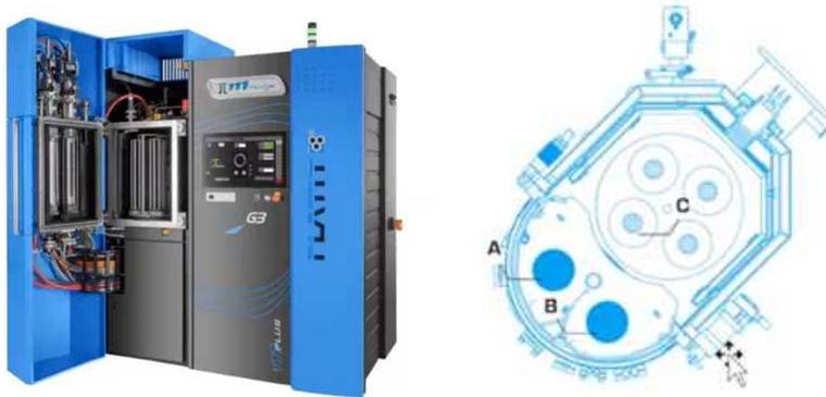
PLATIT のコーティング炉は、特許取得済み回転円筒カソードの採用により、純金属材料を利用したプログラムによる組成比制御が可能です。Pi111 PLUS G3 はコストパフォーマンスモデルでありながら、コーティングの性能はそのままにコンパクトな設計になっています。インハウスコーティング用の前処理から除膜までのターンキーを紹介しています。除膜は、超硬工具の AlCrN にも対応する高い技術力を持っています。
