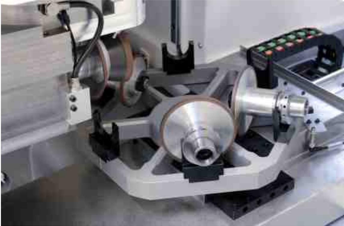
図 7. U-Grind 砥石自動交換システム
