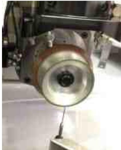
図 8. 砥石測定用機内センサ
