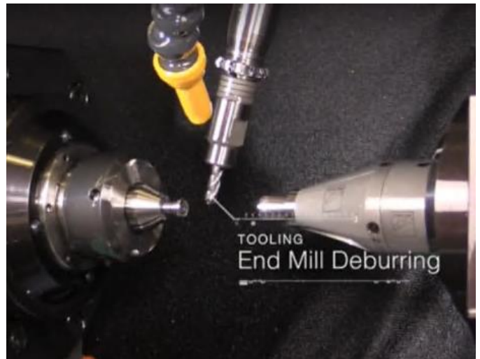
図7：アーバの先端に搭載されたバリ取り用エンドミル
