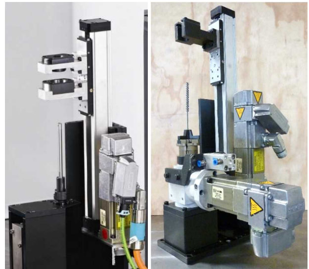
写真6：機内測定ステーション（左）とバリ取りステーション（右）
