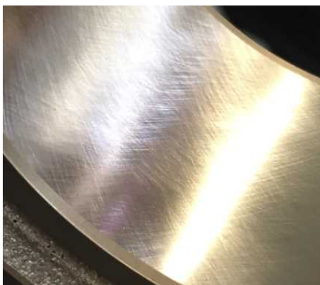
写真 2：高速ホーニングによるクロスハッチ模様
