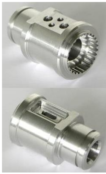
図 14：タレット数別の加工時間 2 材料：アルミ合金 バー材 サイズ： \varnothing 39 x L60 mm 加工時間：64 秒 (C シリーズ) 300 秒 (国産 2 タレット) 420 秒 (国産 1 タレット)
