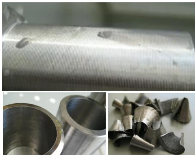
図 6. SUS316L の六角材旋削面 (上、左下) と 6mm 厚の良好な切りくず (右下)
