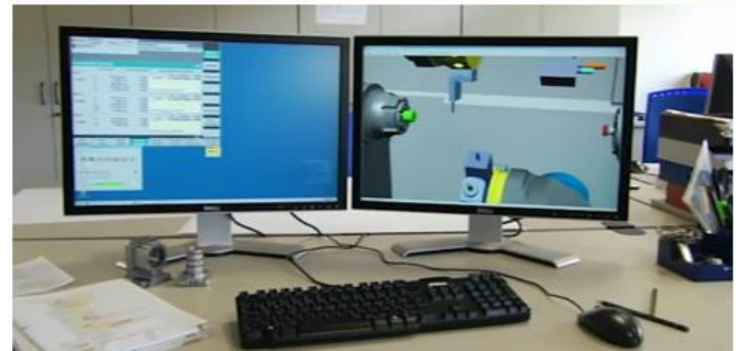
図 17. 機上の操作画面 (上) を機外 PC (下) で再現
