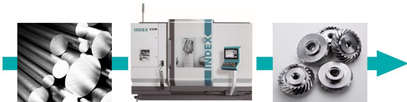
ベベルギヤをバー材からワンチャック全加工を実現する INDEX G シリーズ
