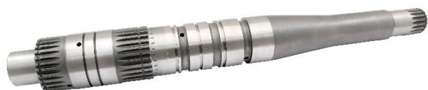
図4 ステディレストとテールストックを用いた加工例（上）と、INDEX Gシリーズが得意とする長尺部品例（下）
