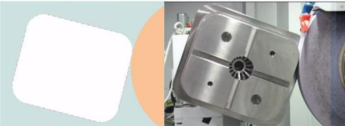
図 10：ポリゴン研削のシミュレーション（左）と実際の加工時（右）
