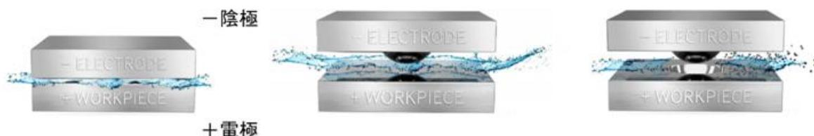
図2 電極とワークが接近および分離する様子
