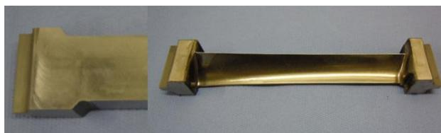
図5 左:タービンブレードのブランク左端
