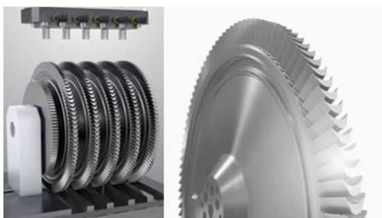
図 7 ブリスクを縦に配置し、5 枚同時加工
