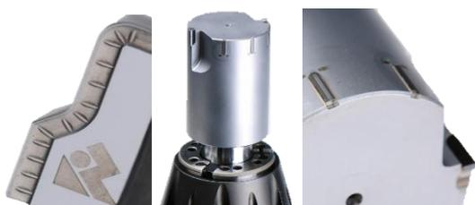
図7. チップブレーカとマージン付き工具
