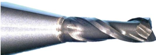
図 11. LS510 femto によるPCDソリッドの加工、面粗さ Ra0.06 μm
