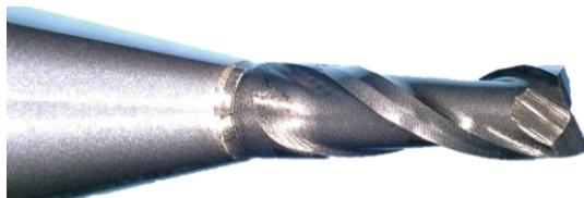
図 11. LS510 femto による PCD ソリッドの加工、面粗さ  $Ra = 0.06 \mu m$
