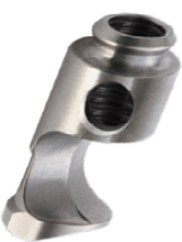
図 5: 加工事例 1 ワーク: チューリップヘッド用ねじ 材料: チタン合金 60 種 / Ti-6Al-4V / バー材 サイズ: \phi 10 \times L23\text{mm} 加工時間: 370 秒
