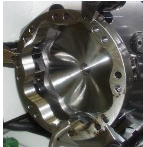
図 4：C 軸を利用した非円筒内面加工
