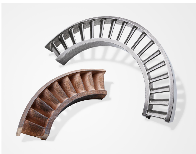
図 6. ブリスクセグメント(左：処理前/右：処理後) 材料：ニッケル基超合金(インコネル)
