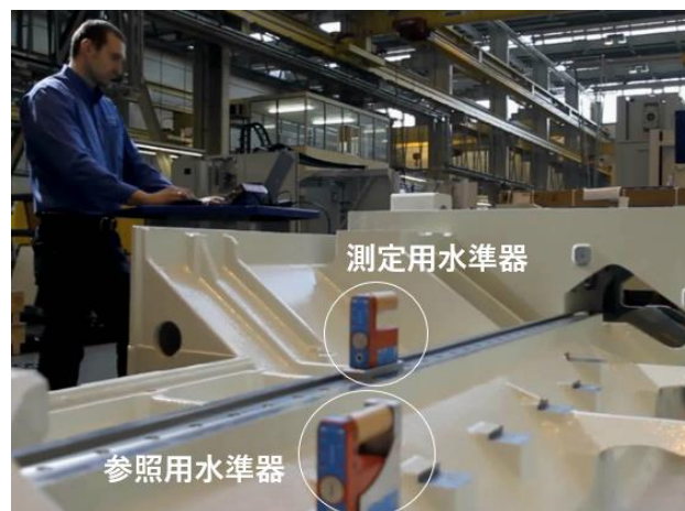
図3 水準器2台による差分測定
