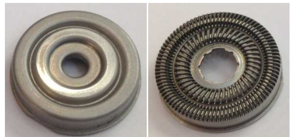
Fig. 4 シェーバーヘッド(左:加工前, 右:加工後) 加工時間 1.5分(4工程, 段取時間除く)
