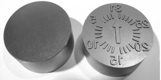
Fig. 3 刻印用パンチ(左:加工前, 右:加工後) 加工時間1分, 加工深さ1mm
