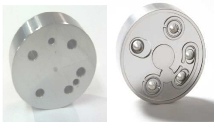
Fig.8 バルブプレート (写真は類似ワーク) (左:加工前, 右:加工後) 高炭素クロム鋼 64 個同時加工, 加工時間 1 個 6 秒
