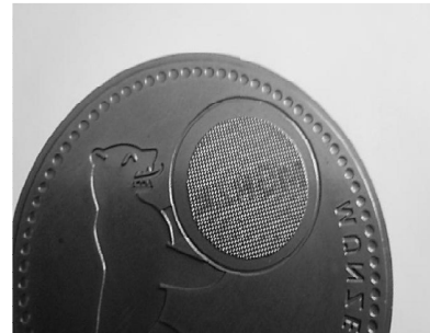
Fig. 6 コイン金型加工、刻印パターンの精工な転写、加工時間7分
