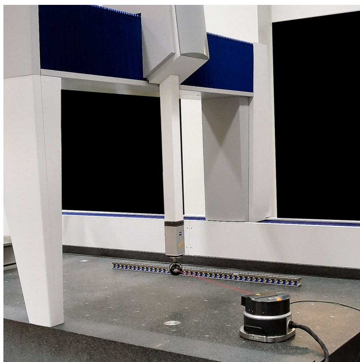
写真 10. エタロンによる三次元測定機の空間補正
