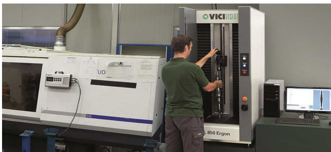
写真 3. 加工機の横に設置される MTL
