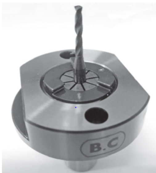
図5 ドリルを予め装着してあるクイックチェンジソケットASSY (株式会社BCテック 提供)
