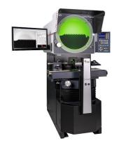
大型治具測定にも対応する水平投影式。
