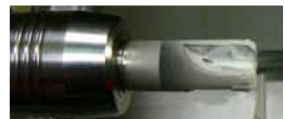
CO 2 ガス冷却による工具の凍結
