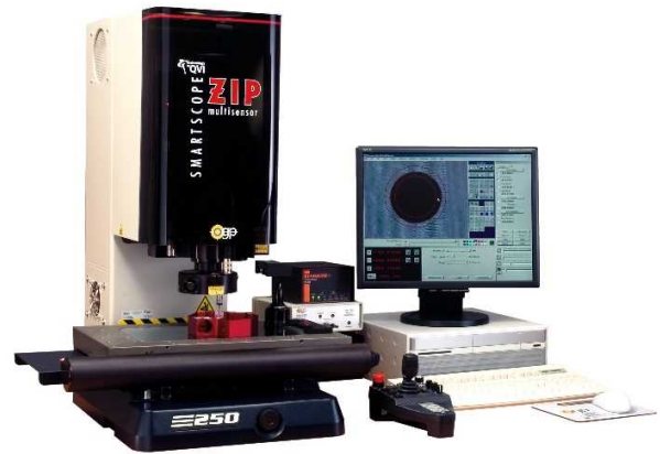
図 1) Smartscope スタンダードモデルの ZIP250E
