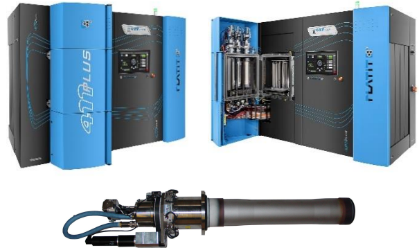
図3 回転円筒カソード PVD コーティング炉 π411(上)と特許回転円筒カソード(下)
