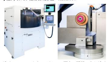
砥石メーカーでもある ASA は、顧客の要望に応え砥石の成形品質、作業の省力化を追求し、2011 年に湿式 CNC5 軸砥石成形盤を作り上げました。同社の砥石成形盤は砥石と共に、多くのロロマティックユーザに使用 されています。ASA300w シリーズは砥石径 280mm、複数枚の砥石パックの場合 200mm までの成形に対応 し、スピンドル胴径 60mm と 80mm 仕様があります。
