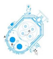
プラティットのコーティング炉は、特許取得済み回転円筒カソードの採用により、純金属材料を利用したプログラムによる組成比制御が可能です。Pi111 PLUS はコストパフォーマンスモデルでありながら、コーティングの性能はそのままにコンパクトな設計になっています。インハウスコーティング用の前処理から除膜までのターンキーを紹介しています。除膜は、超硬工具の AlCrN にも対応する高い技術力を持っています。
